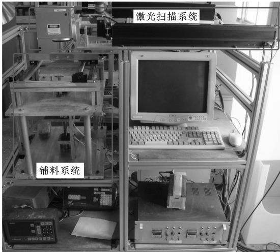
图2 陶瓷激光固化法快速成型实验机
